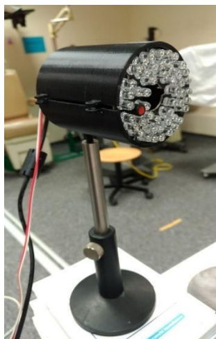
Rys. 21. Meibograf na statywie skonstruowany na potrzeby badania.
