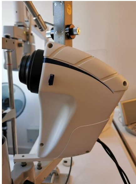
Rys. 12. Głowica obrazująca meibografu IDRA, Afidera GmbH, Berlin. [12].
